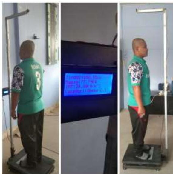
Gambar 6. Pengujian Perangkat IMT Meter
